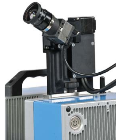
Die M-Cam lässt sich mit wenigen Handgriffen montieren.
